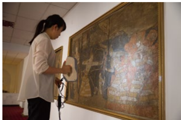
壁画表面の凹凸を三次元計測する
