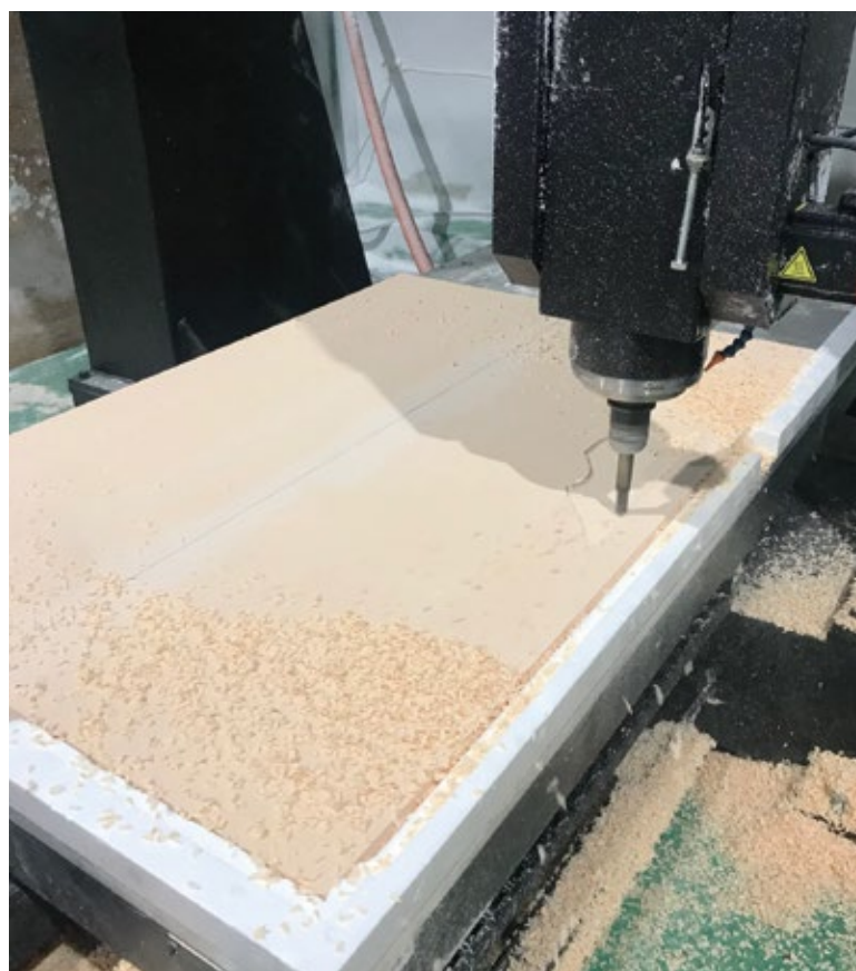
壁画表面の3Dデータをもとに表面を切削する
